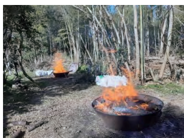
図3 開放型炭化器による竹炭製造
